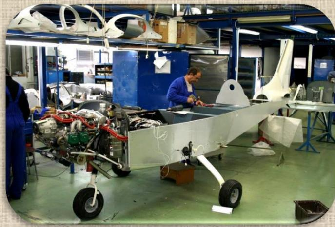
La cellule est désormais terminée, et les quelques pièces composites assurant la finition et l'aérodynamisme de notre futur joujou sont fixées sur la structure métallique. L'ensemble assure robustesse, facilité de maintenance et une ligne épurée et moderne.
