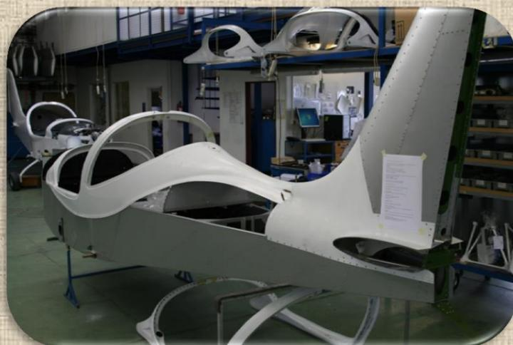
La cellule métallique, anodisée contre la corrosion permet une durée de vie supérieure aux autres avions de même catégorie. L'ensemble de la structure est assemblée par une combinaison de rivets et collage afin d'accroître sa robustesse et sa durée de vie. Ce qui fait du **Sportstar** un des avions les plus appréciés par sa robustesse et sa fiabilité dans les écoles de pilotage du monde entier.
